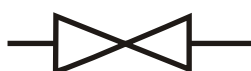
Вариант 2. Знак "Вентиль проходной". Шаровой кран так обозначать неверно, но обозначают так часто.
